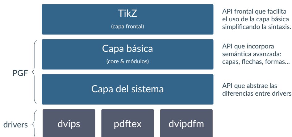
Figura 1: Estructura en capas de TikZ
